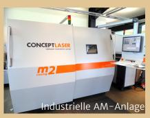
man allerdings nicht von 3D-Druck, sondern von "Additive Manufacturing" (AM), zu Deutsch additive Fertigung. Im Januar 2016 startet dann nach der Installation einer weiteren AM-Anlage die Serienproduktion. Laut Premium Aerotec ist das Unternehmen das einzige im Flugzeugbau, welches über die gesamte Produktionskette zur Herstellung von Flugzeugteilen nach dem AM-Verfahren verfügt.
