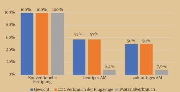
Sowohl der verringerte Materialverbrauch, als auch die leichteren Bauteile bzw. Flugzeuge sprechen für die nachhaltige Technologie des Additive Manufacturing und reduzieren den ökologischen Fußabdruck von Flugzeugen.
